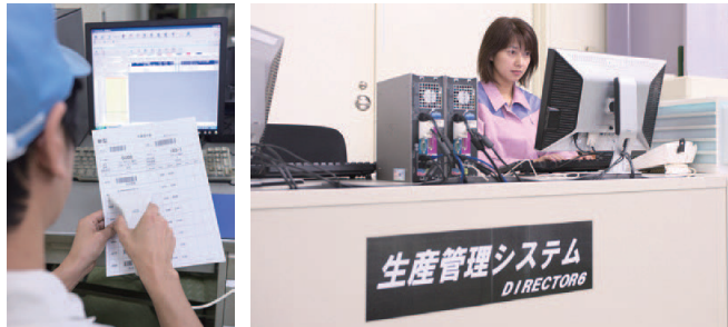
バーコード入力による クライアント端末 作業の進捗管理
